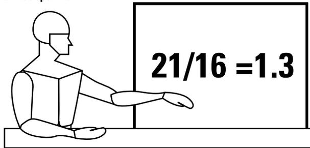
La plupart des appareils et des ordinateurs qui se trouvent dans les bureaux ou les écoles sont utilisés de façon continue pendant de nombreuses heures. Dans de telles situations, les codes nationaux de l'électricité limitent habituellement les circuits à 80% de leur capacité. Notre système électrique est conçu pour des circuits de 20 ampères chaque. Alors, 80% de 20A correspond à 16 ampères. Vous devez donc diviser le nombre total d'ampères par 16.
